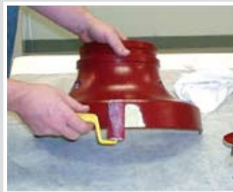
La peinture est appliquée sur une surface apprêtée. La peinture devrait déborder sur la surface environnante.
