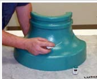
La peinture est appliquée sur une surface apprêtée. La peinture devra déborder sur la surface environnante.
