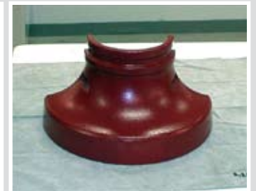
La peinture est appliquée sur une surface apprêtée. La peinture devrait déborder sur la surface environnante.
