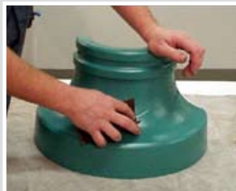
Nettoyage mécanique de la surface
